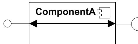
Abbildung 1: Abhängigkeiten zwischen angebotener und benötigter Schnittstelle
